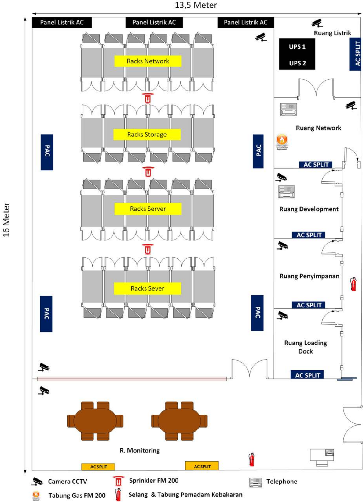
Gambar 17 Target Arsitektur Data Center
