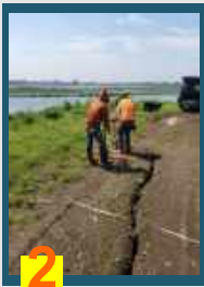
2 Survei Georadar (memantau retakan tanggul)
